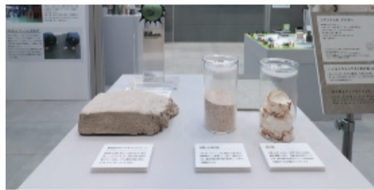
卵の殻を活用したバイオマス製品「バイオミックストーン」の製造過程
